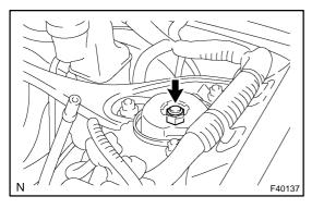
(d) Fully tighten the lock nut.
