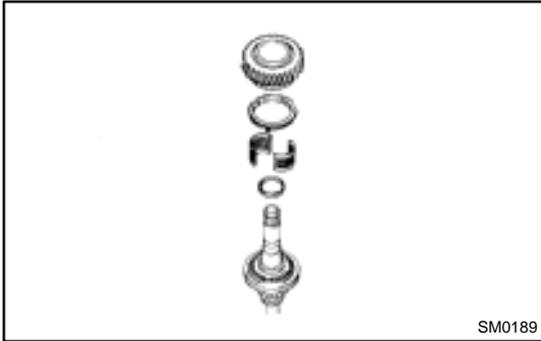
**5. INSTALL SYNCHRONIZER RING, NEEDLE ROLLER BEARING, SPACER, 4TH GEAR AND REAR BALL BEARING**
