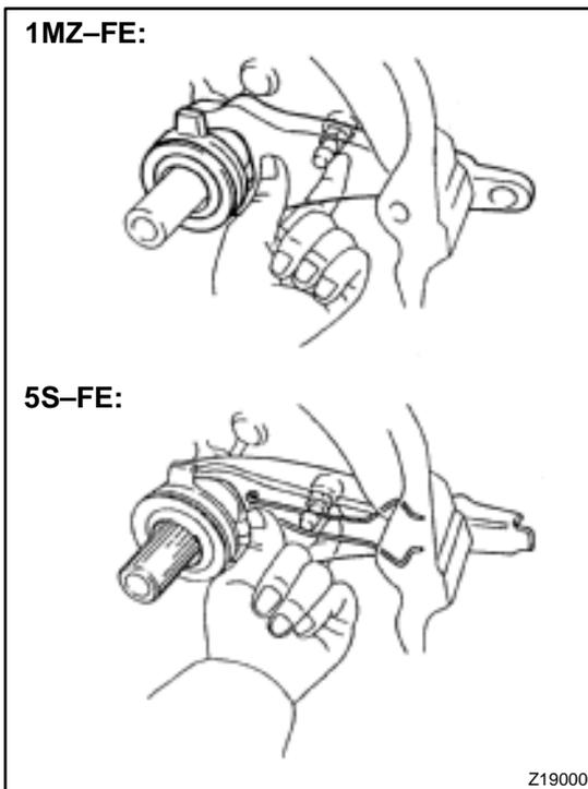
3. **REMOVE RELEASE BEARING AND FORK FROM TRANSAXLE**
